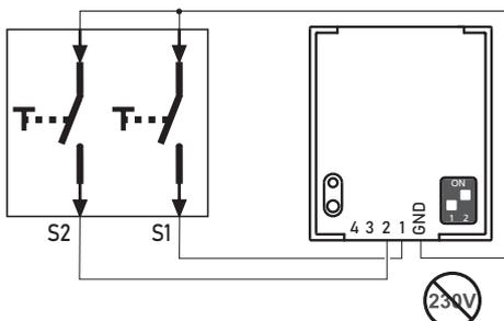
Der Sender sendet bei einer Zustandsänderung eines angeschlossenen Schalters einen Schaltimpuls von ca. 0,5 Sekunden.
